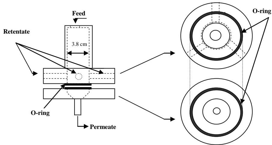
Figure 1 Membrane module
