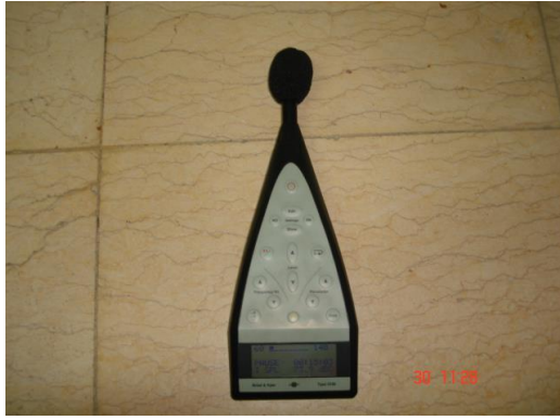
Fig. (4) SPL meter B&K 2236
